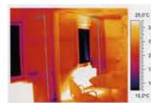
Aufnahme Wärmebildkamera Homogene Temperaturverteilung beschichteter Räume
