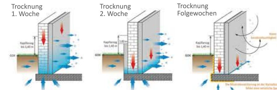
Nach Abschluss des Entfeuchtungsprozesses übernimmt der Dämmputz die **Dampfregulierung** im Innenbereich und schafft ein **angenehm trockenes Klima**.
